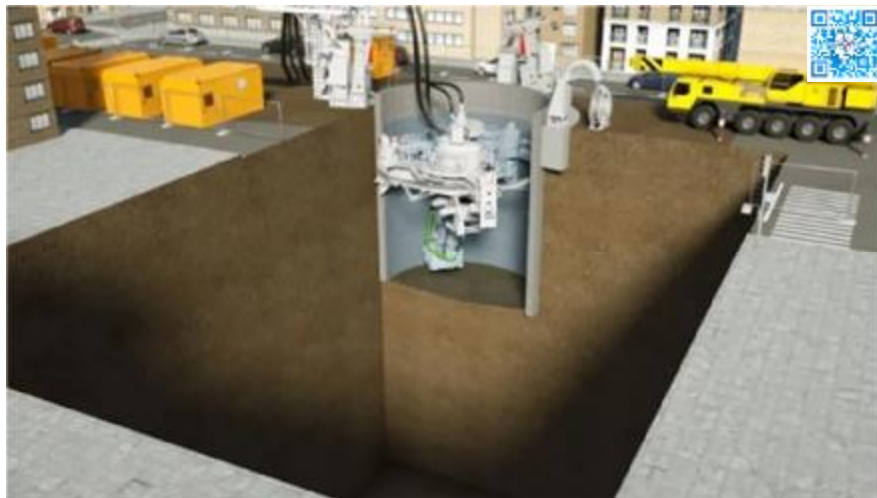
图 30 VSM沉井施工示意图
