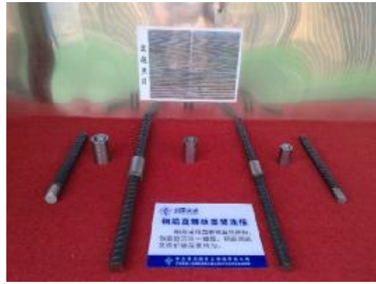
图 15 钢筋直螺纹套筒连接展示
