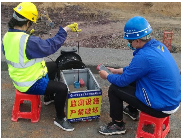
图 12 深层水平位移监测
