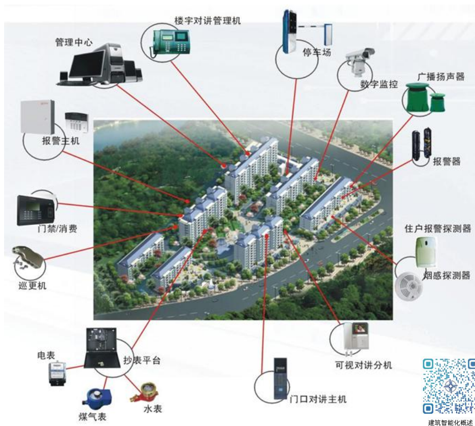
图 36 建筑智能化应用
