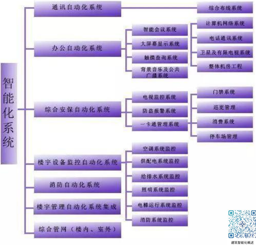
图 35 建筑智能化系统
