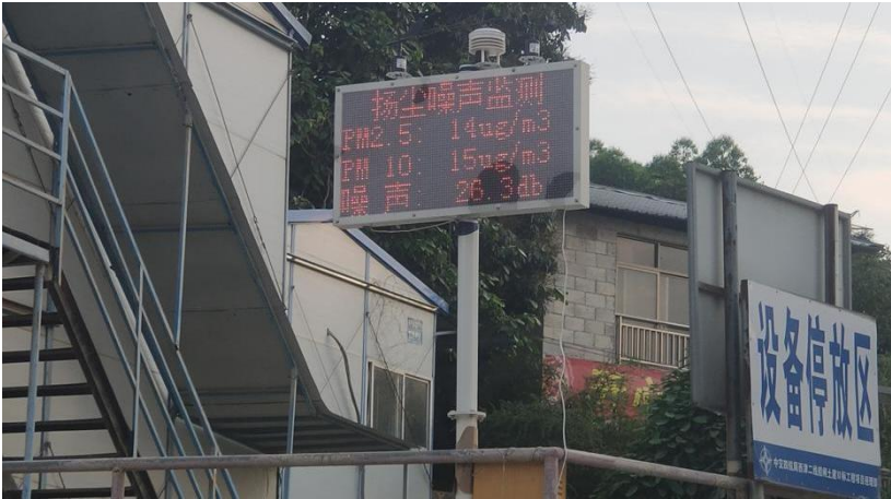
图 14 扬尘噪声监测系统
