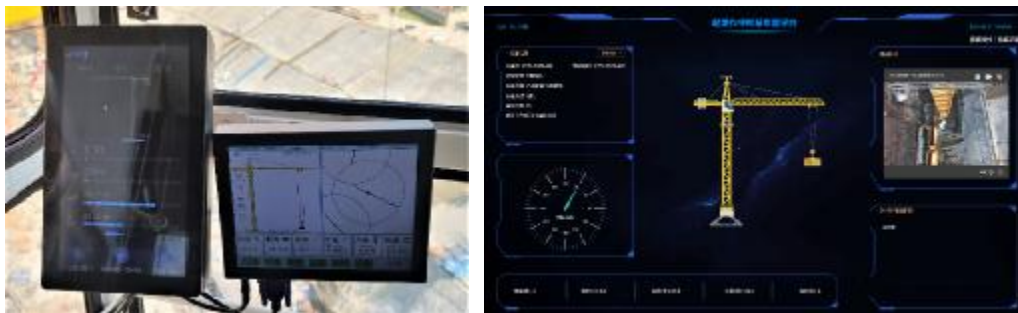
图 16 塔机安全监控管理系统与起重作业智慧监管平台
