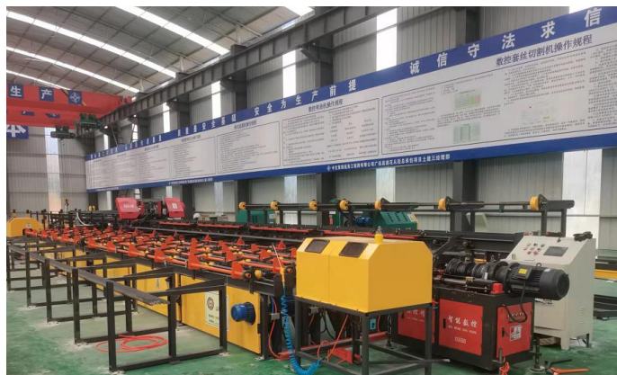
图 20 智能钢筋锯切、套丝、打磨生产一体机
